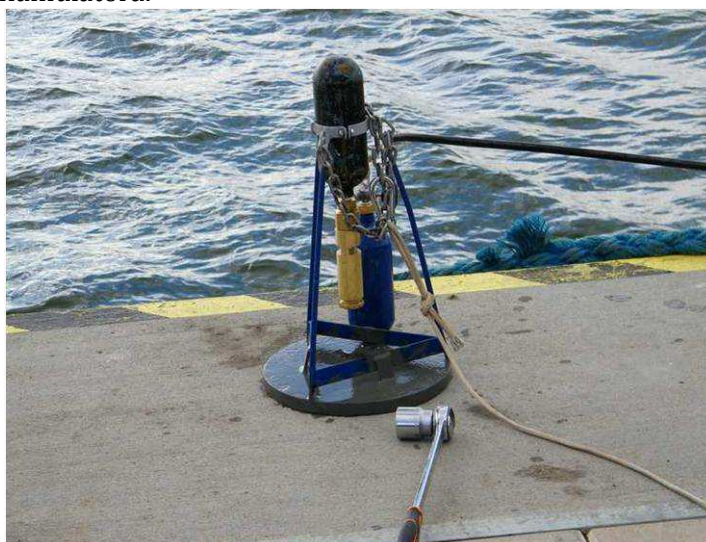
Rys. 5. Model działka pneumatycznego ze sprężyną i akumulatorem.
