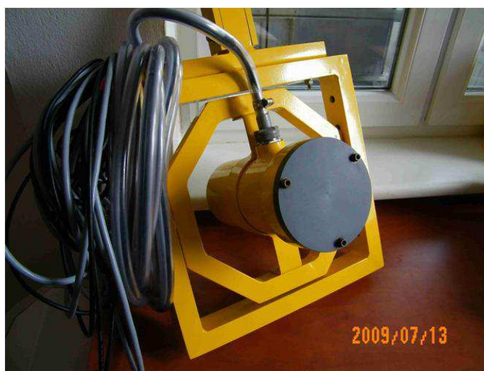
Rys. 2. Przykładowy pojedynczy moduł nadawczy do badań modelowych.
