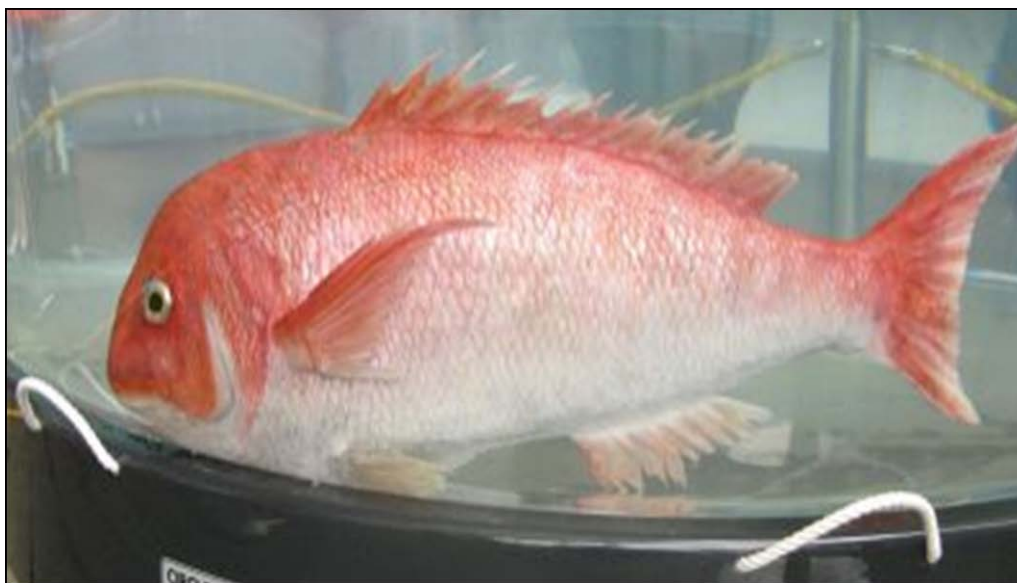
Rys. 3. Pojazd podwodny z napędem falowym (Tai robot kun), zaprojektowany na Uniwersytecie w Kitakyushu (Japonia) - http://xorsyst.com/japan/realistic-robotic-fish/
