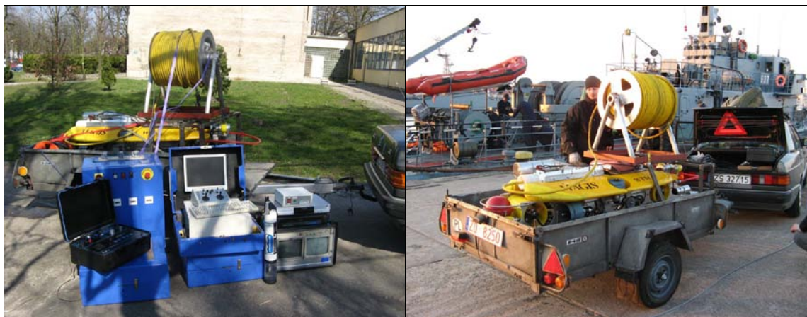
Fot. 3. System Monitoringu Głębiny – podzespoły oraz transport pojazdu MAGIS i kablinoży na przyczepie samochodowej.
