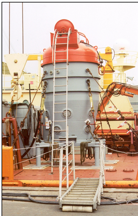
Rys. 8. Dzwon ratowniczy McCann'a [S. Poleszak]
