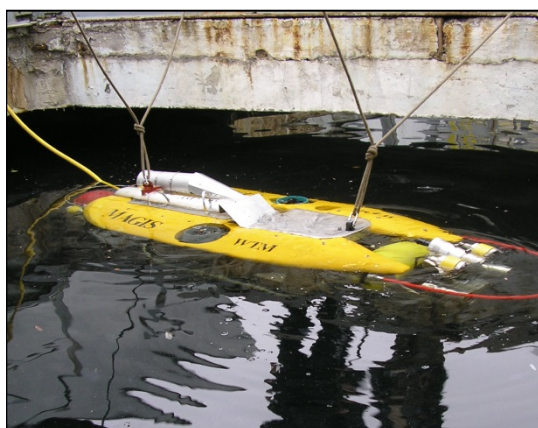
Rys. 8 Badania właściwości pojazdu głębinowego MAGIS w basenie technologicznym Zakładu Technologii Okrętów Politechniki Szczecińskiej.
