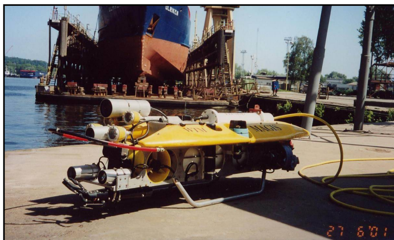
Rys. 7 Pojazd głębinowy MAGIS podczas badań stanu technicznego doku pływającego w Szczecińskiej Stoczni Remontowej Gryfia.
