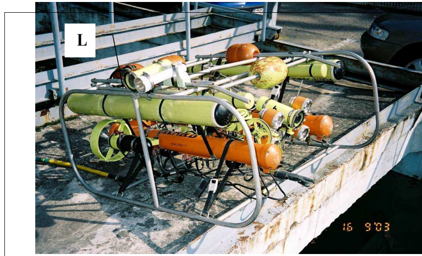
Rys. 3 Bezałogowy zdalnie sterowany pojazd głębinowy KRAB II wyposażony w znacznik laserowy L do badań trajektorii ruchu pojazdu.
