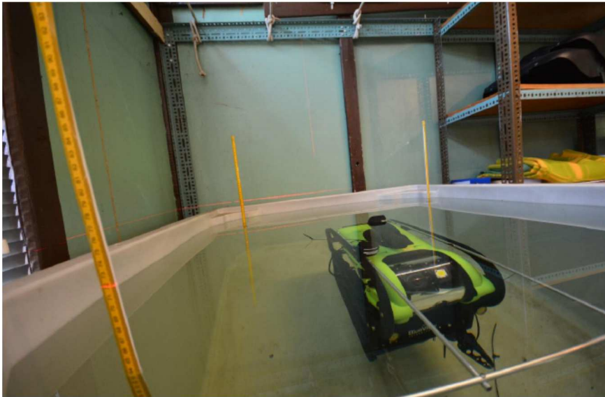
Rys. 4 Pojazd ROV Seabotix LBV 200 podczas eksperymentu w basenie testowym.
